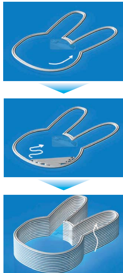
[그림 1] FDM 타입 3D 프린터 구조 및 적층 원리
