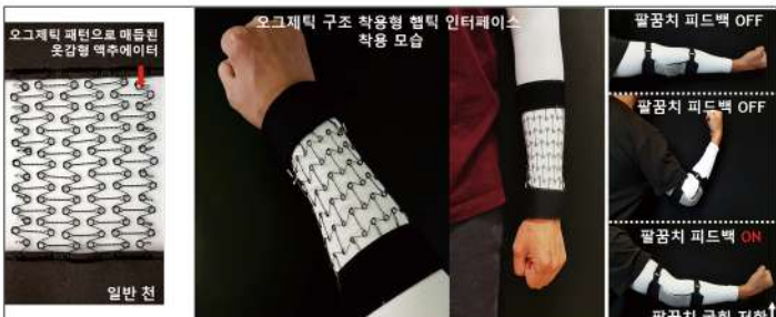
형상기억합금 와이어를 오그제틱(auxetic) 구조로 매듭지어 제작한 옷감형 액추에이터와 이를 활용해 개발한 착용형 햅틱 인터페이스
