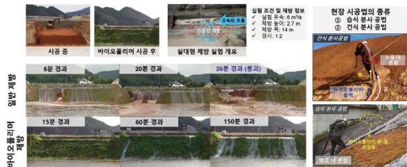
그림3. 바이오폴리머 제방의 우수성 확인을 위한 현장 적용 실험
