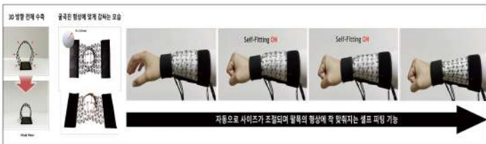
3D 방향 전체 수축기능을 보이고, 굴곡진 형상에 맞게 구조를 감싸며, 자동으로 사이즈가 조절되어 팔목의 형상에 착 맞춰지는 셀프 피팅 구현
