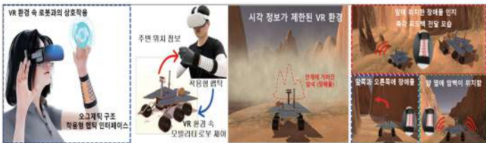
오그제틱 패턴으로 매듭지어진 착용형 햅틱 인터페이스를 통해 VR 환경 속 모바일 로봇의 주변 환경에 대한 정보를 전달받고 모바일 로봇을 제어
